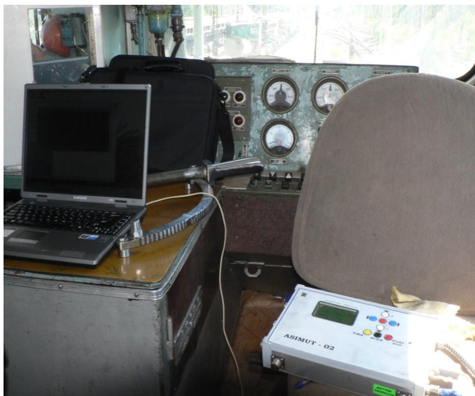
Рис. 4 – Блок индикации параметров карьерного железнодорожного транспорта БИП-ГТ2 в кабине машиниста тягового агрегата №391 ОАО «Ураласбест»
