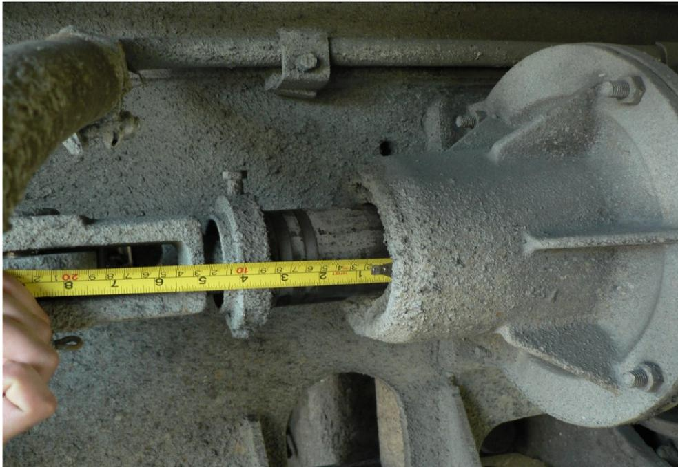
Рис. 3 – Замер выхода штока тормозного цилиндра электровоза управления тягового агрегата №391 ОАО «Ураласбест»
