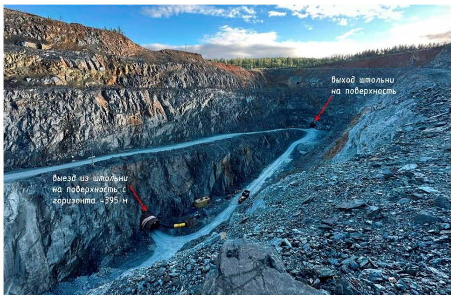
Рис. 3. Промежуточный карьер, выходы подземных горных выработок на поверхность
