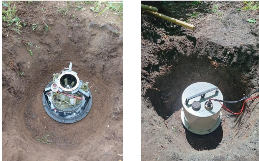
Рис. 3. Устройство пунктов микросейсмических наблюдений с датчиками СМ-3КВ на поле шахты «Калиновская-Восточная»
