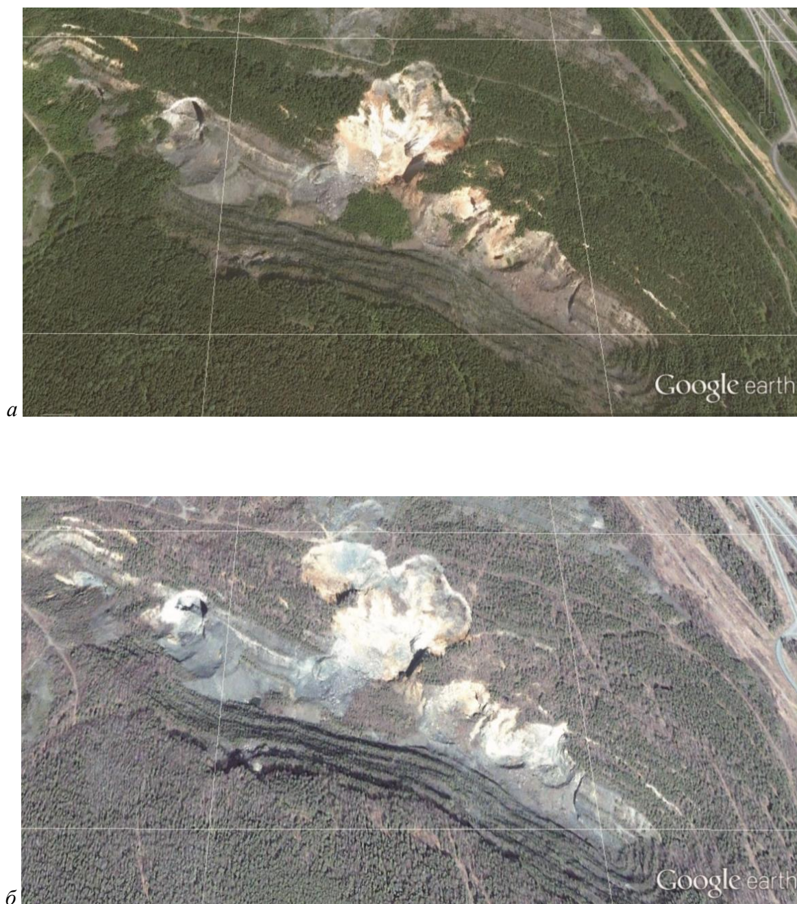
Рис. 3 - Космический снимок территории Естюнинского месторождения: а – до обрушения 2012 г.; б – после обрушения 2012 г.
