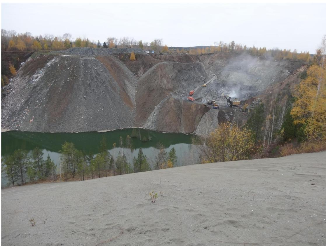
Рис. 2 – Доработка запасов целлика промплощадки шахты «Эксплуатационная» открытым способом после ликвидации ствола и затопленная зона обрушения
