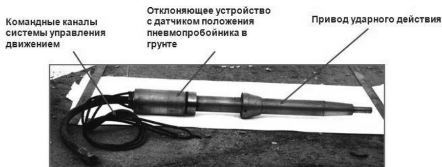
Рис. 3 – Макет управляемого пневмопробойника по схеме изменения его внешней формы
