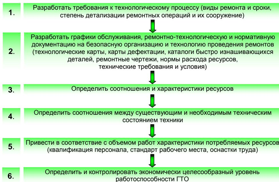
Рис. 3 – Блок-схема формирования стандарта процесса ремонтного и технического обслуживания горной техники и оборудования (ГТО)
