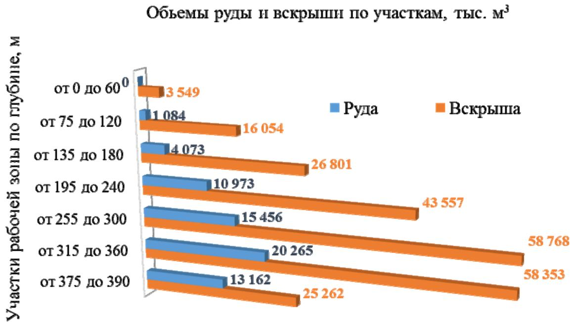
Рис. 7. Распределение объемов вскрыши и руды по глубине карьера
