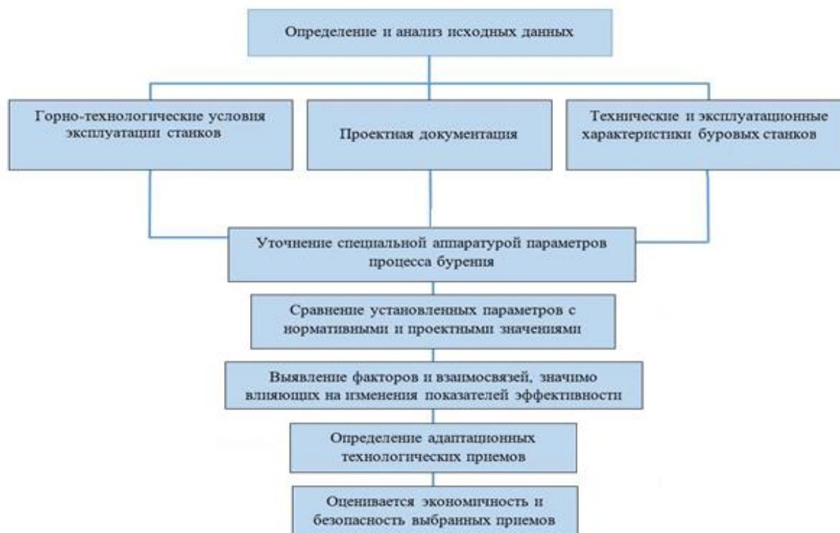
Рис.3. Порядок обоснования выбора технических решений для адаптации буровых работ с учетом изменения горнотехнических условий
