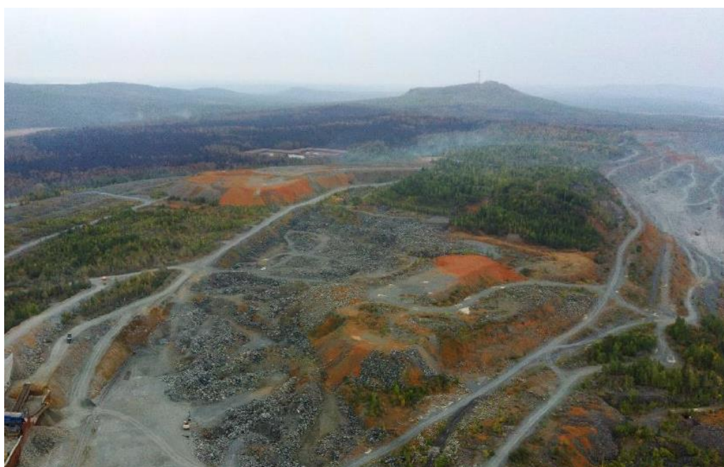
Рис. 1. Отвал вскрышных пород
