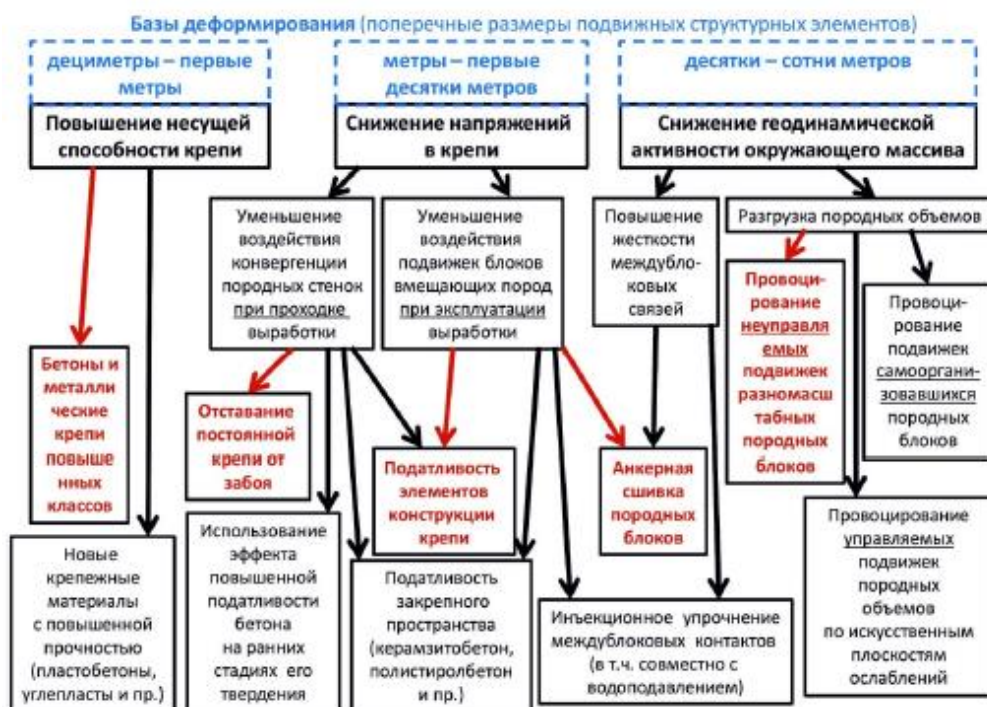
Рис. 9. Взаимные связи между основными технологиями предотвращения негативного влияния современных геодинамических движений на крепь подземных сооружений и масштабами деформирования элементов системы «крепь – массив горных пород»
