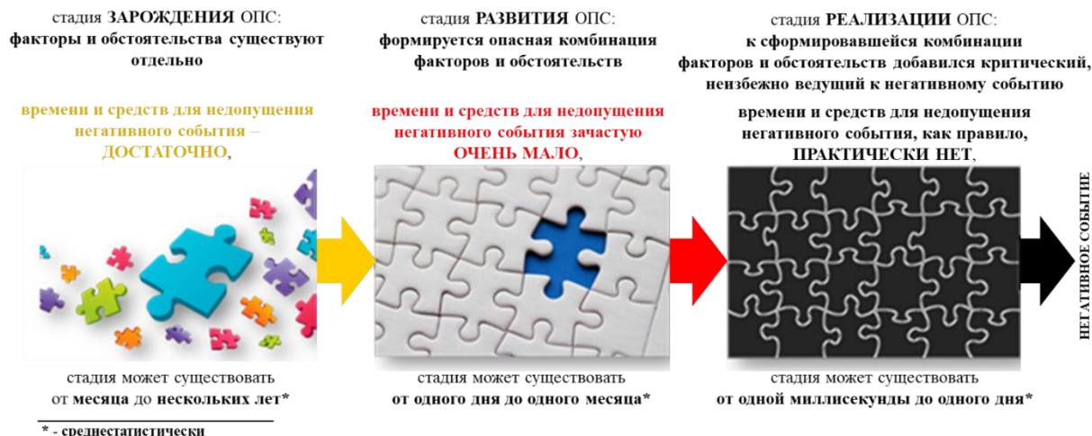
Рис. 3. Модель зарождения, развития и реализации опасной производственной ситуации в негативное событие
