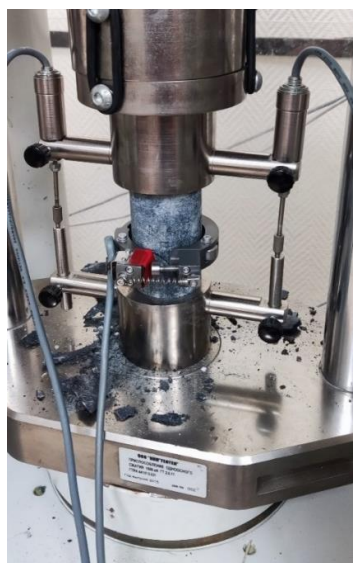
Рис. 2. Приспособление одноосного сжатия и датчики измерения деформаций образца горной породы
