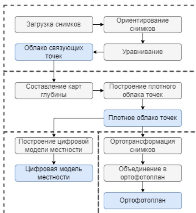
Рис. 2. Последовательность фотограмметрической обработки в Metashape
