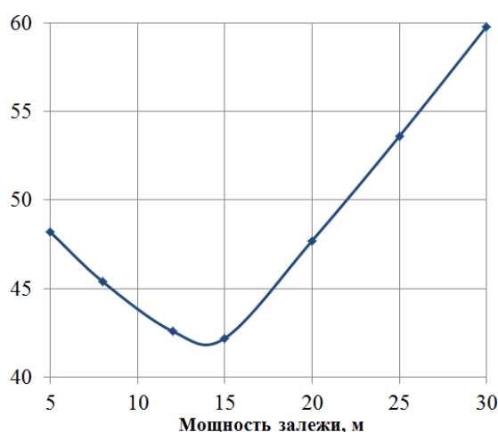
Рис. 3. Зависимость величины потерь руды в целиках при камерно-столбовой системе разработки от мощности залежи
