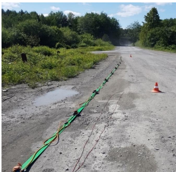
Рис. 3. Расстановка буксируемой косы
