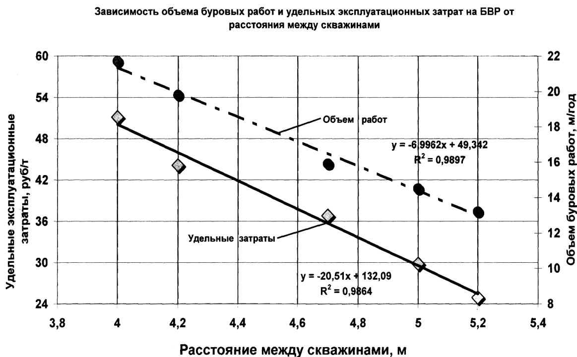
Рис. 4. Влияние расстояния между буровыми скважинами на объем буровых работ и удельные эксплуатационные затраты на БВР
