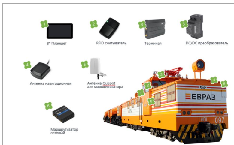
Рис. 9. Оснащение локомотивов системами позиционирования
